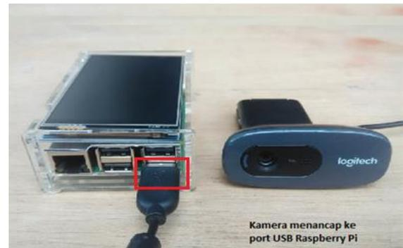
Gambar 6. Pemasangan kamera pada *port* USB Raspberry Pi 3
