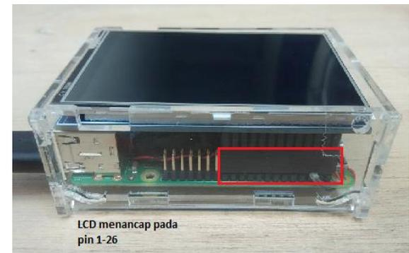
Gambar 7. Pemasangan LCD pada GPIO *pin* 1 - 26 Raspberry Pi 3
