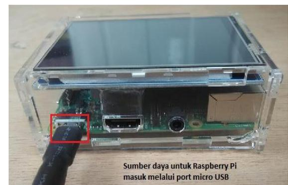
Gambar 8. Sumber daya Raspberry Pi 3 masuk melalui *port micro* USB
